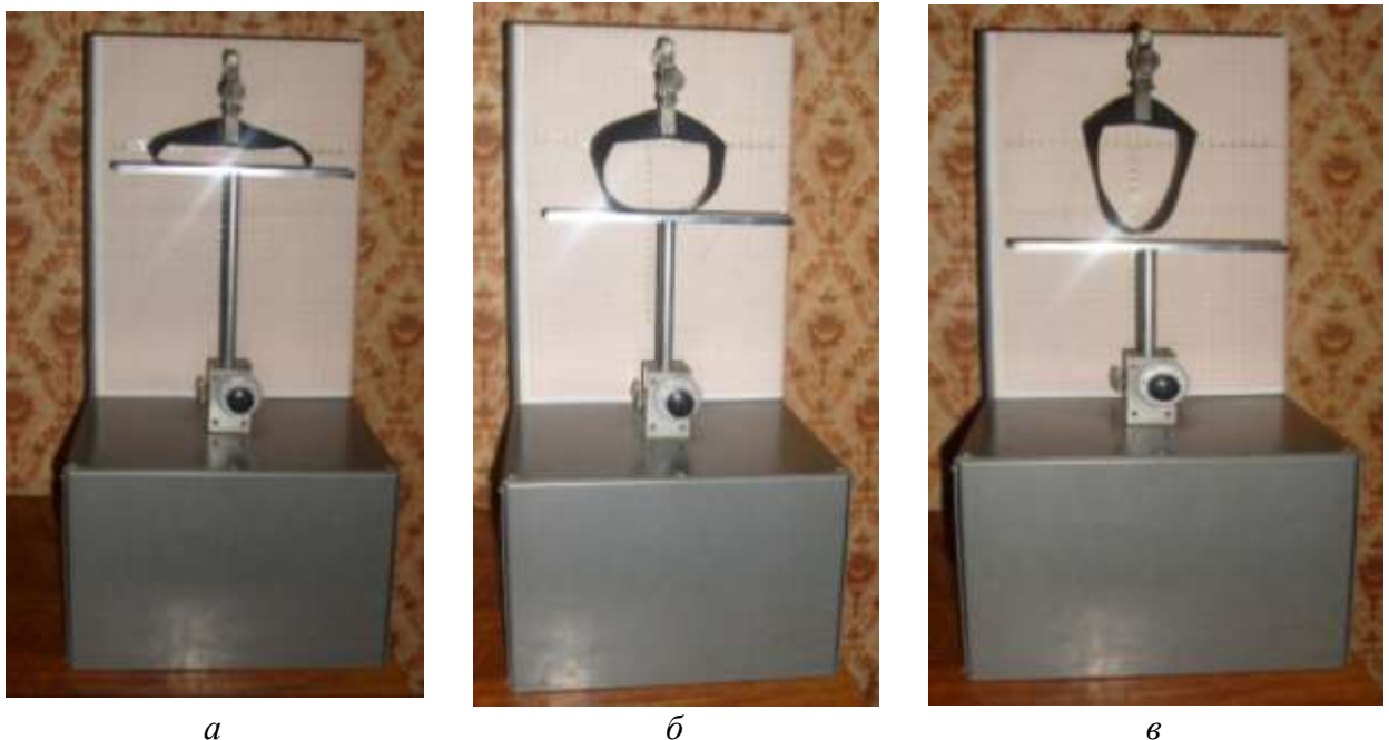
Рис.4.2. Внешний вид прибора и пробы текстильных материалов на разных этапах испытаний: а – исходное положение после закрепления пробы в зажим 8 , б – промежуточное положение при опускании горизонтальной платформы 5 , в – окончательное положение в момент прекращения контакта горизонтальной платформы 5 с пробой
