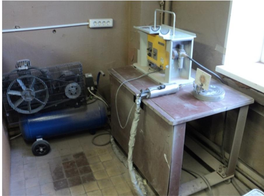
Рис. 3.5. Комплекс для нанесения покрытий сверхзвуковым холодным напылением
