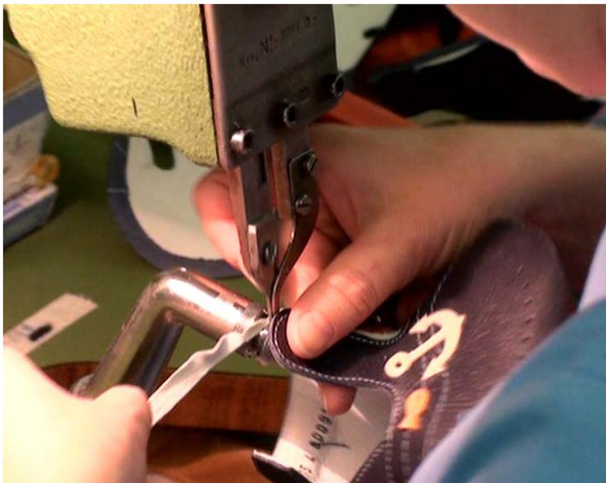
Рис. 1.8. Нож машины для срезания излишков подложки деталей обуви
