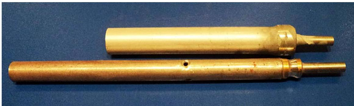
Рис. 3.6. Общий вид модернизированных сопел для холодного напыления порошковых материалов высокоскоростным воздушным потоком
