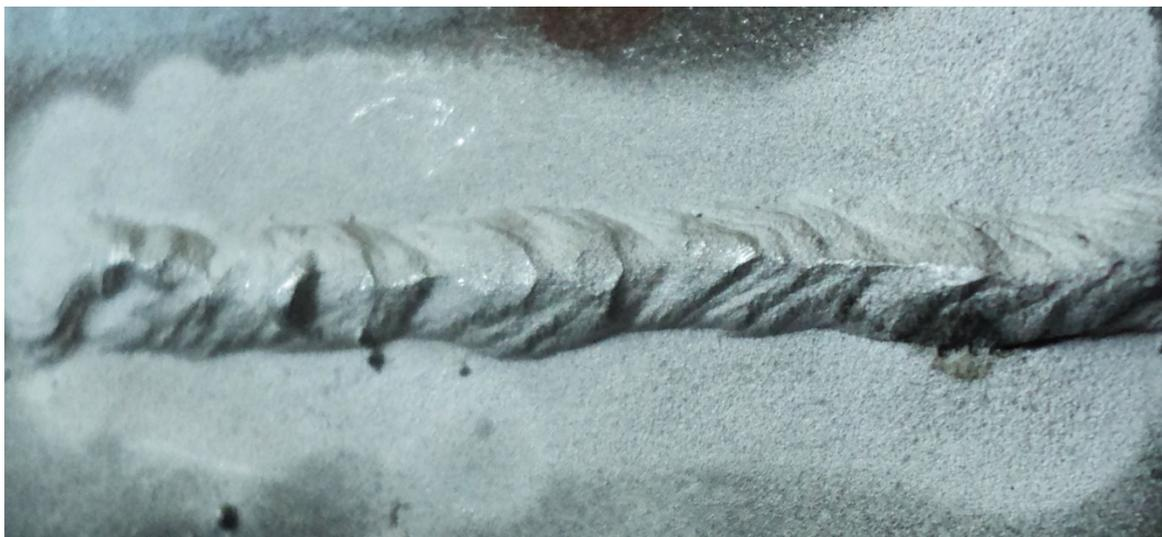
Рис. 4.23. Антикоррозионное покрытие из цинка на сварном шве
