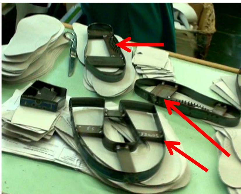
Рис. 1.6. Резки для вырубания деталей обуви
