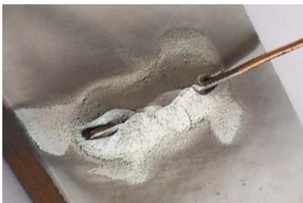
Рис. 4.24. Соединение медного прутка с кафельной плиткой алюминием
