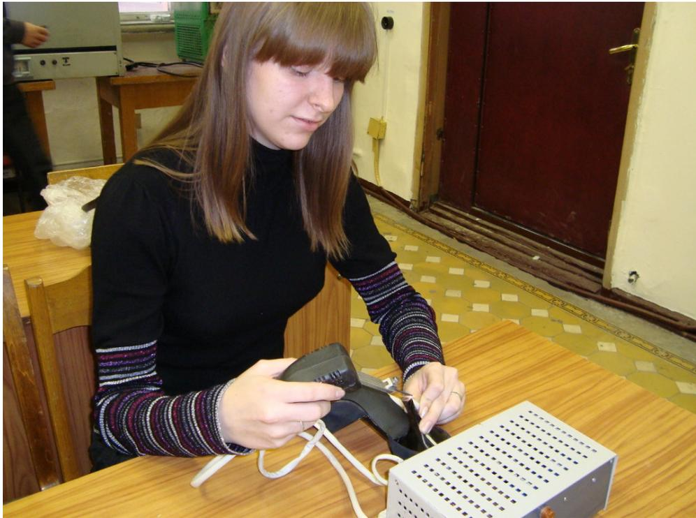
Рис. 4.16. Нанесение противозносного покрытия на каблук обуви
