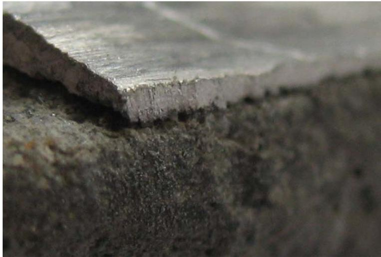
Рис.4.10. Покрытие из алюминия на бетоне толщиной 2 мм
