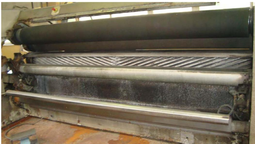
Рис.1.5. Ножевой вал строгальной машины
