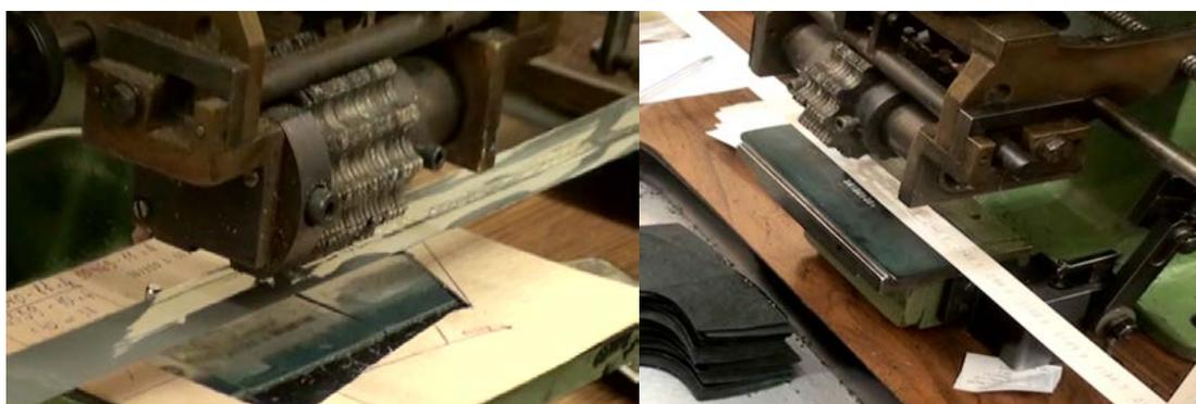
Рис.1.3. Исполнительный механизм клеймения деталей обуви
