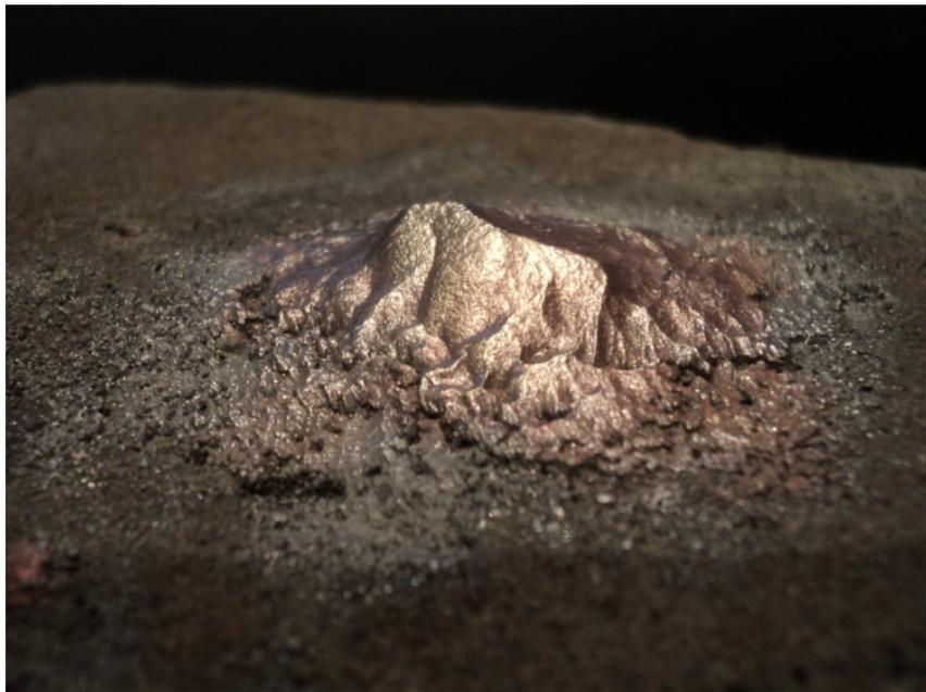
Рис. 4.22. Объемная фигура из меди с алюминиевой подложкой на бетоне
