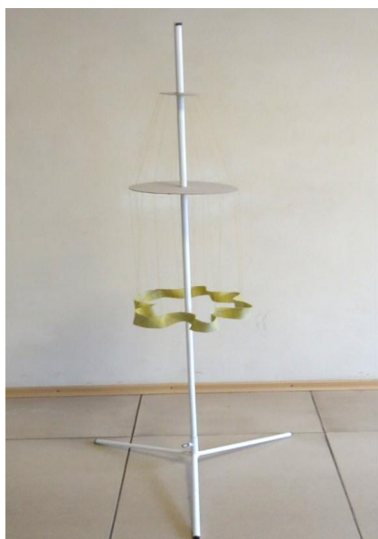
Рис. 7 – Стенд для исследования пространственной формы замкнутого элемента тонкой оболочки
