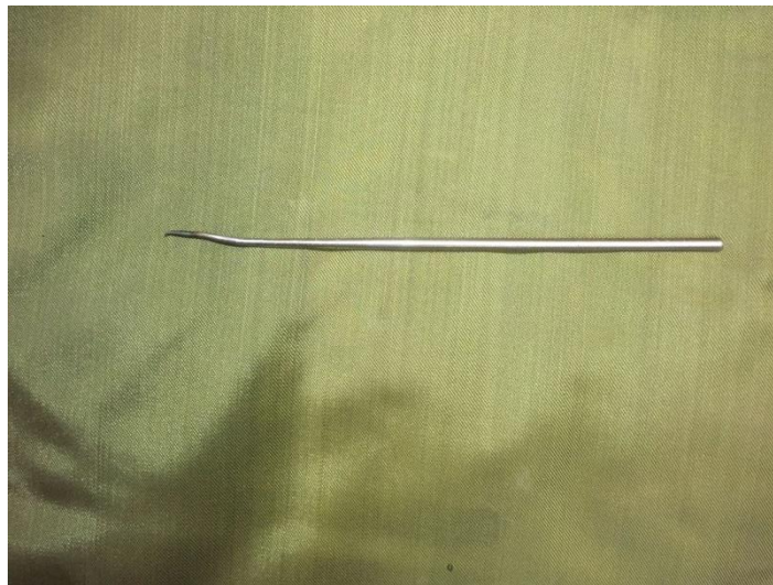
Рисунок 3.5 – Фотография деформированного индентора
