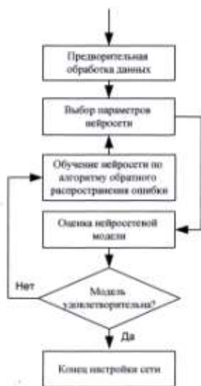
Рисунок 4.3 – Схема обучения нейроконтроллера при помощи алгоритма обратного распространения ошибки
