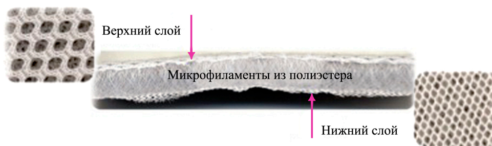
Рисунок 1 – Основовязанный двойной трикотаж с соединительными протяжками «knitted spacer fabrics»; верхний и нижний слои различных структур.
