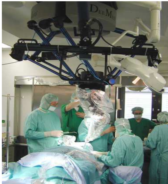
Рис. 1.31. Манипулятор Delta для перемещения медицинского оборудования
