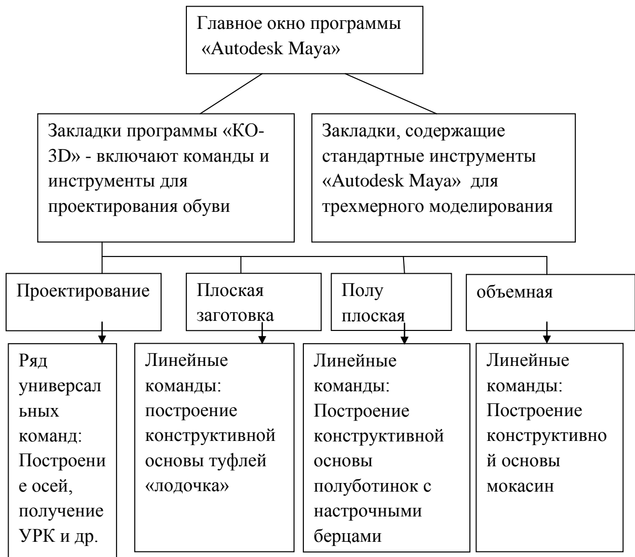
Рисунок 57.Схема интерфейса программы «КО-3D»
