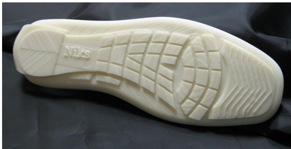
Рисунок 8. Опытный образец подошвы, изготовленный с помощью технологии быстрого прототипирования
