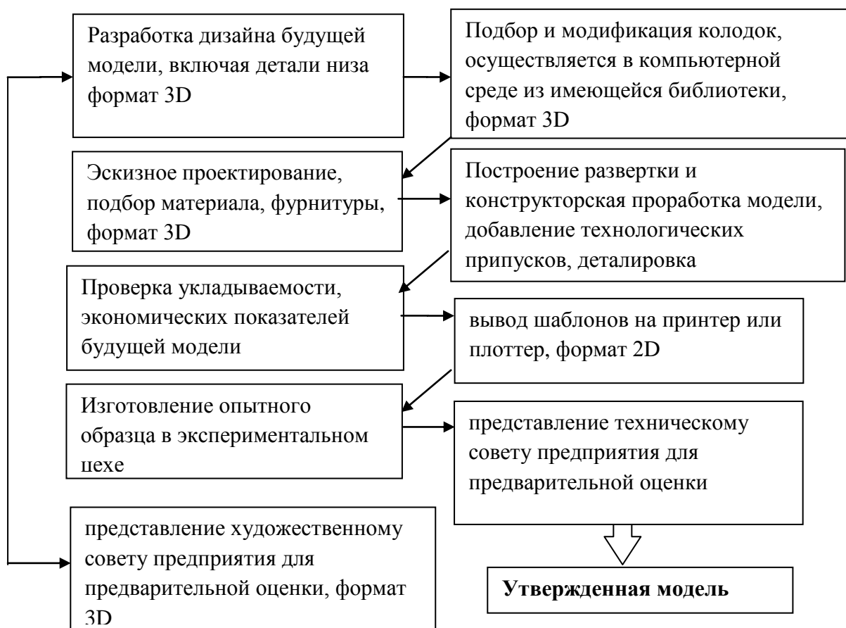
Рисунок 3. структурно-логическая схема проектирования обуви с использованием САПР, поддерживающих 3D формат.
