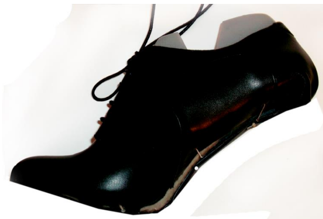
Рисунок 72. Заготовка полупары обуви спроектированной с помощью подпрограммы «КО-3D» затянутая на колодку.
