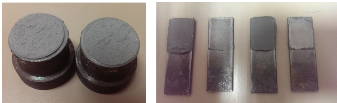
Рис. 7. Образцы после испытаний на отрыв (а) и сдвиг (б)
