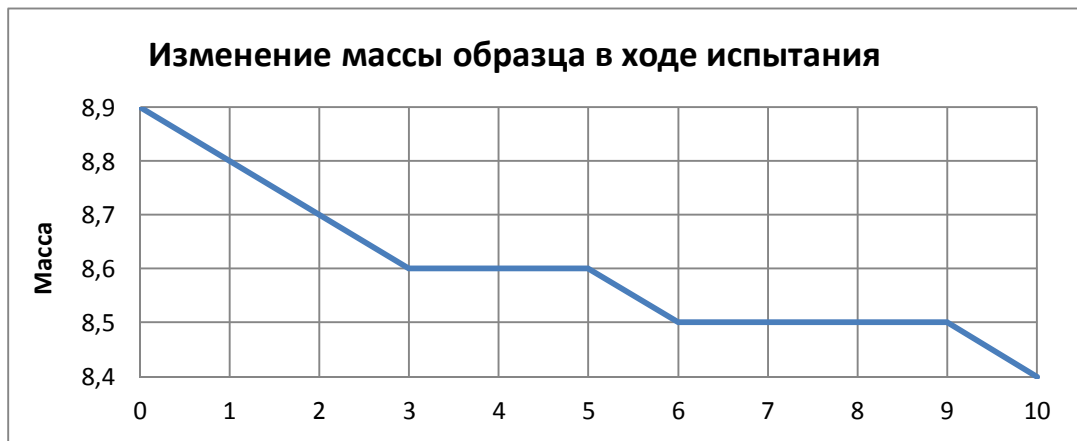
Рис. 11. Потеря массы образца вследствие его изнашивания с течением времени
