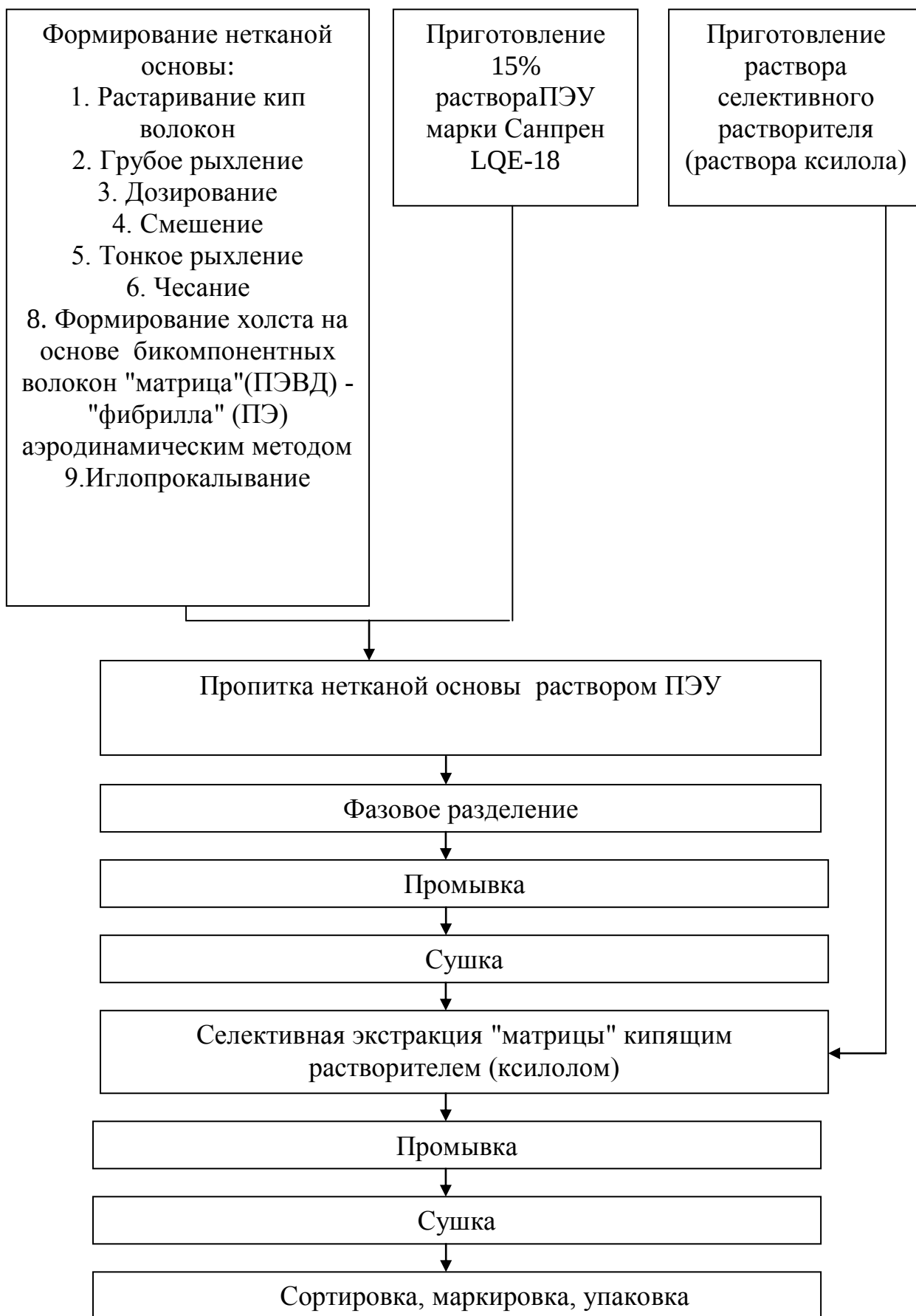
5.14. Блок-схема производства СКМ
