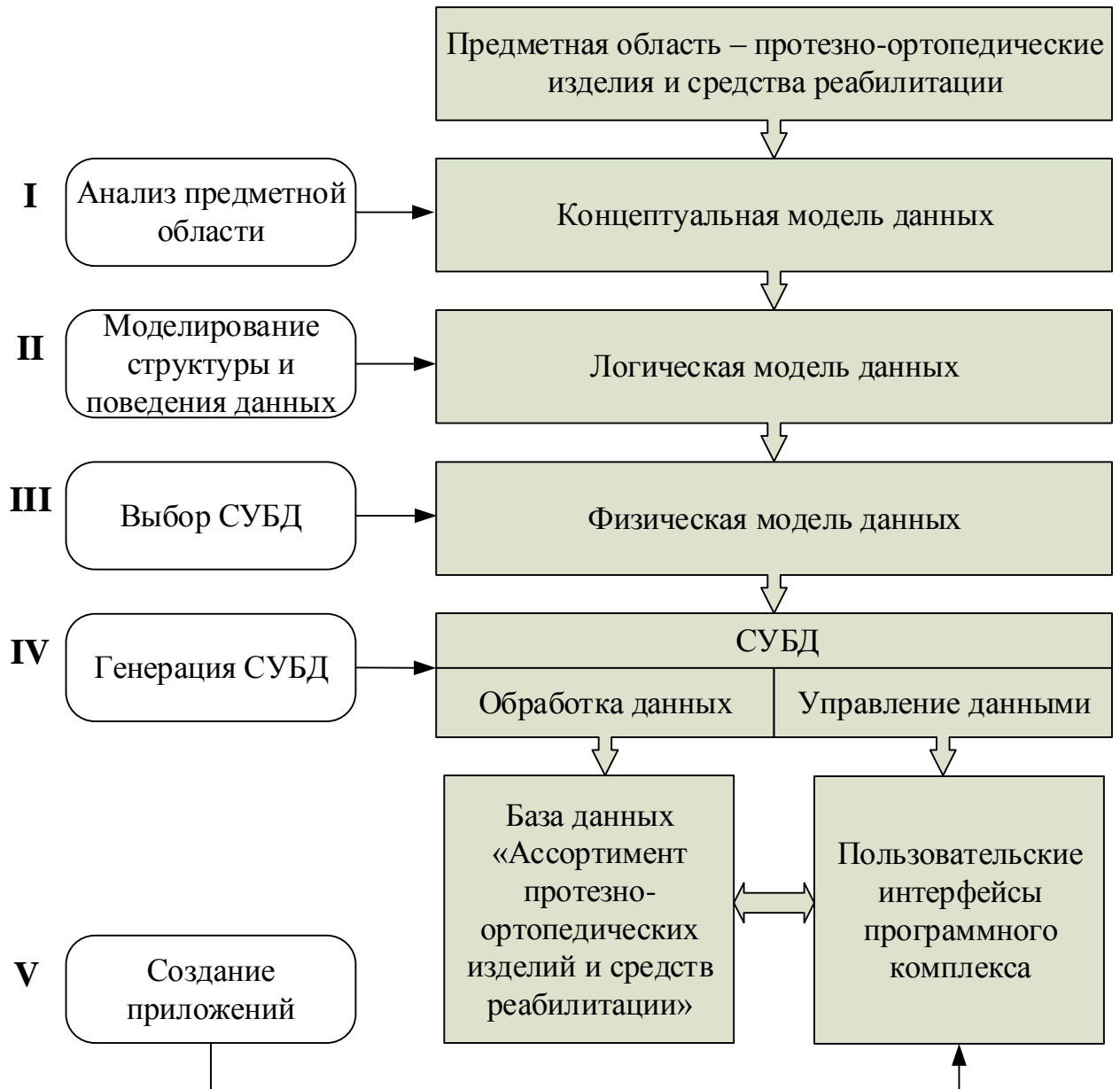
Рисунок 3.1. Этапы проектирования базы данных, основанной на реляционной модели данных
