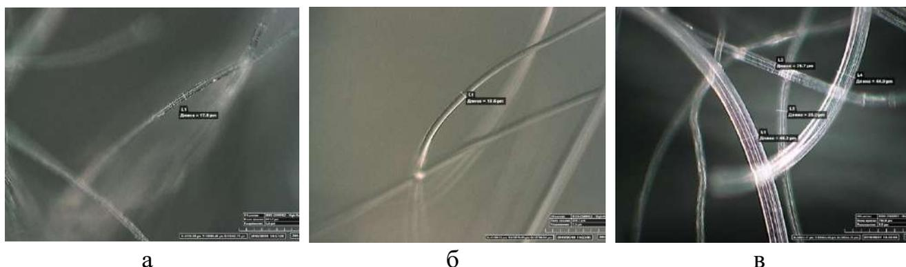
Рис. 3.26. Вид волокон ТНМООПК под микроскопом: а - 0,33; б – 0,44; в – 0,77; 2,22 текс [244]
