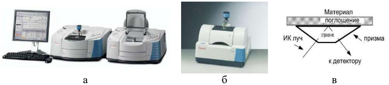
Рис. 3.23. Спектрометр: а – Nicolet iS5; б – оборудование внутреннего отражения (неполного); в – схема работы
