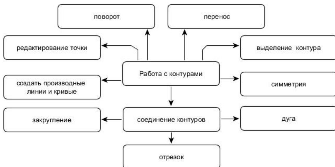
Рисунок 3.19 Функциональные возможности работы с контурами
