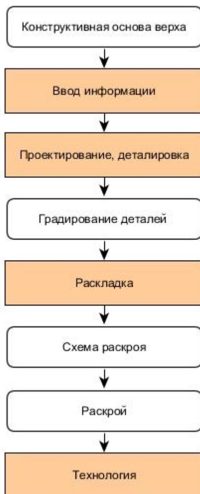
Рисунок 1.15 Структурно-логическая схема проектирования обуви
