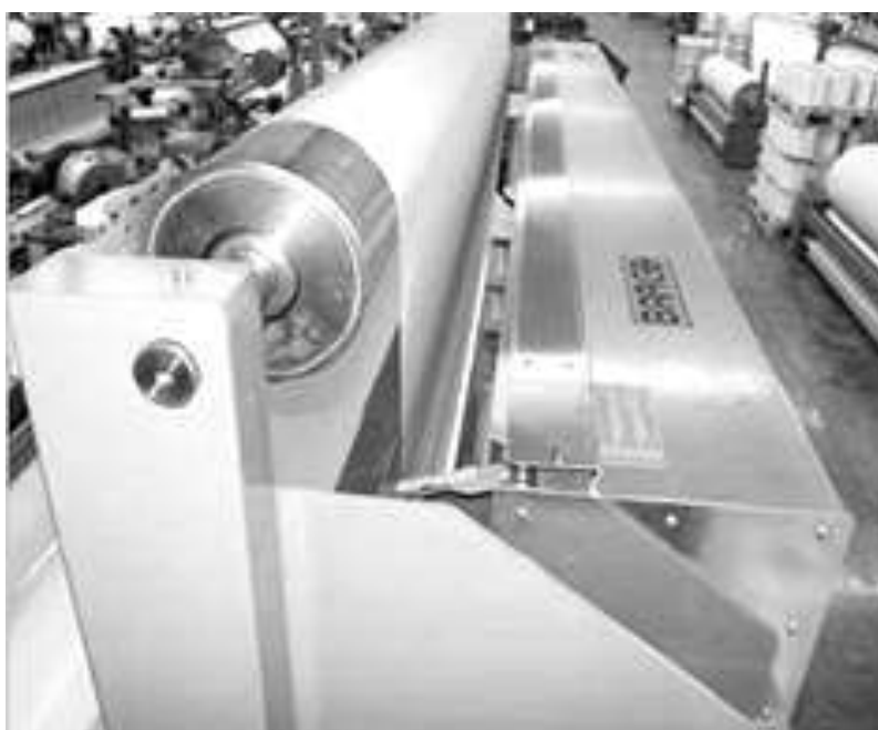
Рис. 7. Система контроля качества ткани Cyslors фирмы Вагсо
