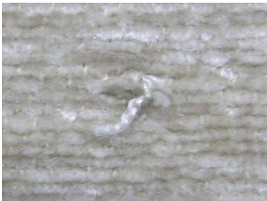
Рис. 37. Узел – местный порок в виде связанных концов нитей, заметных на лицевой стороне полотна
