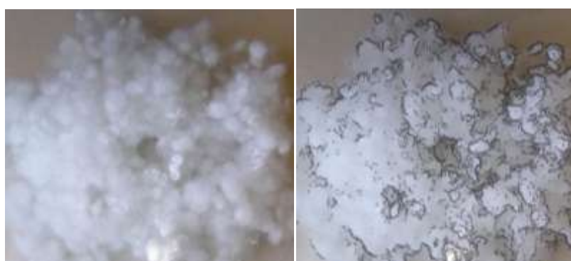
Рис. 128. Изображение синтетического наполнителя в виде шариков до и после определения контуров
