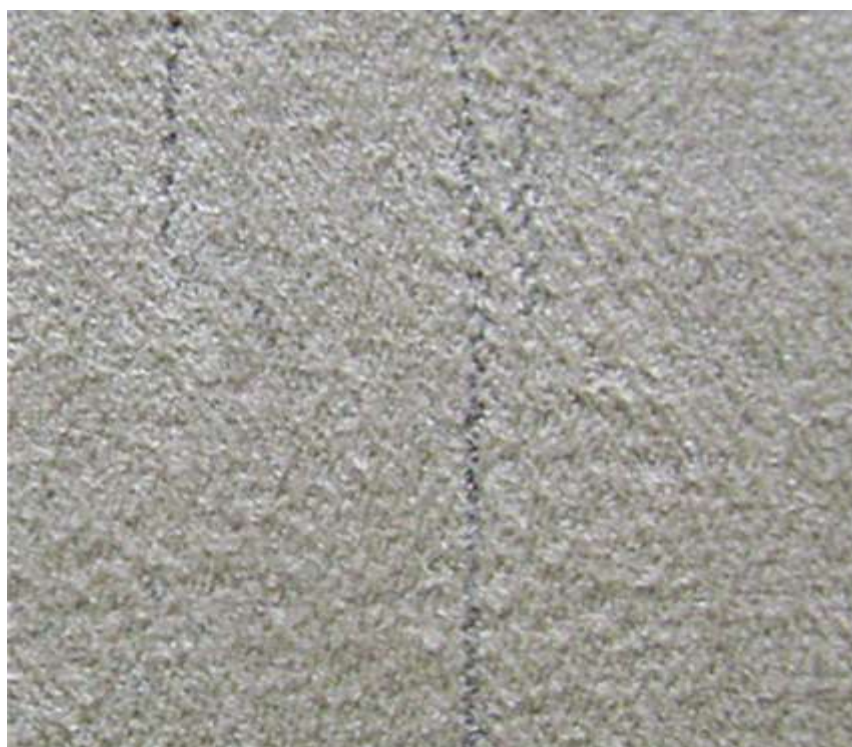
Рис. 39. Отсутствующая нить – местный порок в виде отсутствия нити
