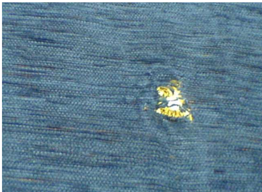
Рис. 36. Дыра – местный порок, при котором разрушена целостность полотна
