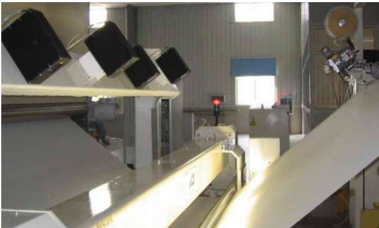
Рис. 5. Система контроля качества нетканых материалов компании ISRA Vision AG
