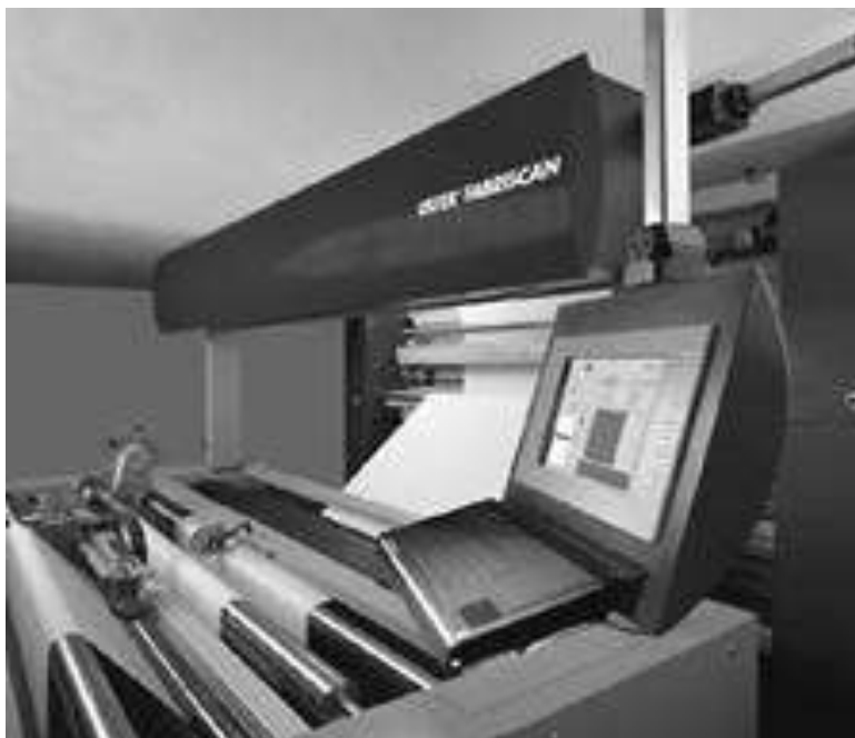
Рис. 6. Система для обнаружения ткацких дефектов Fabriscan
