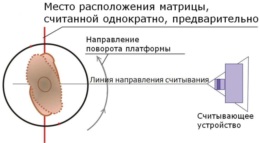
**Рисунок 4.6 - Схема расположения фигуры человека и считывающего устройства в мобильной системе 3D сканирования**
