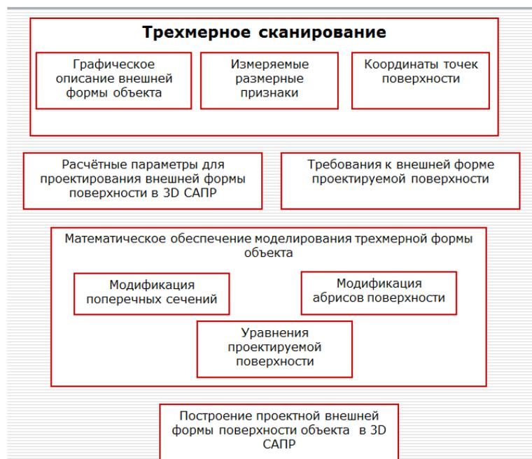
**Рисунок 6.23 - Структура БД для проектирования внешней формы поверхности в 3D САПР**
