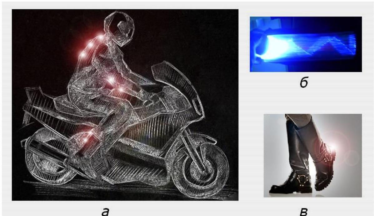
**Рисунок 6.10 - Конструктивные элементы одежды и обуви с применением оптоволокна: а - костюм мотоциклиста, б-верхняя часть перчатки мотоциклиста, в - сапоги**
