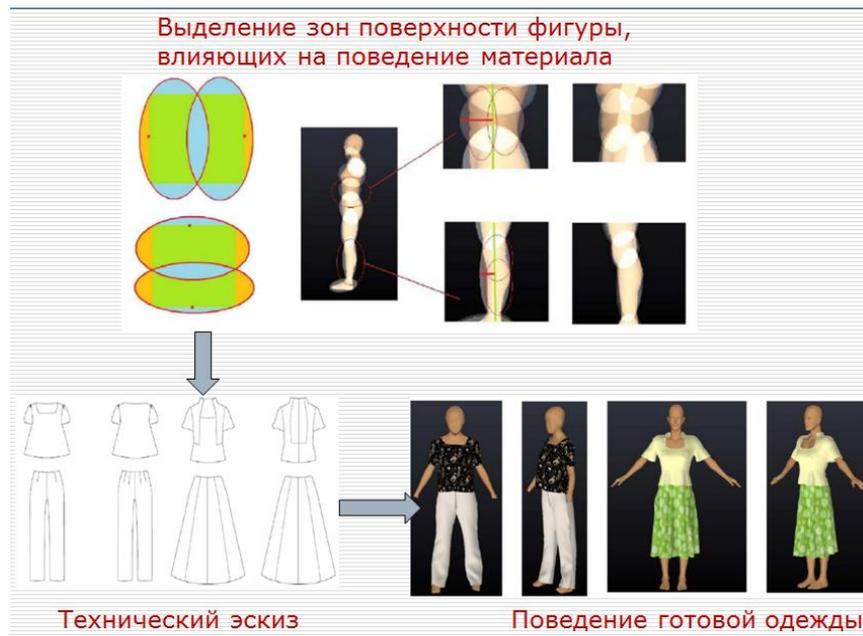
**Рисунок 2.35 – Реалистичная виртуальная примерка 3D моделей проектируемых изделий с учетом кривизны поверхности фигуры и свойств материала [414]**
