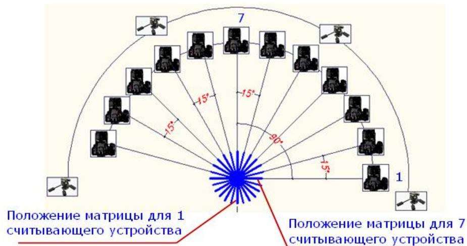
**Рисунок 4.5 - Схема положения материальной матрицы для настройки оборудования**
