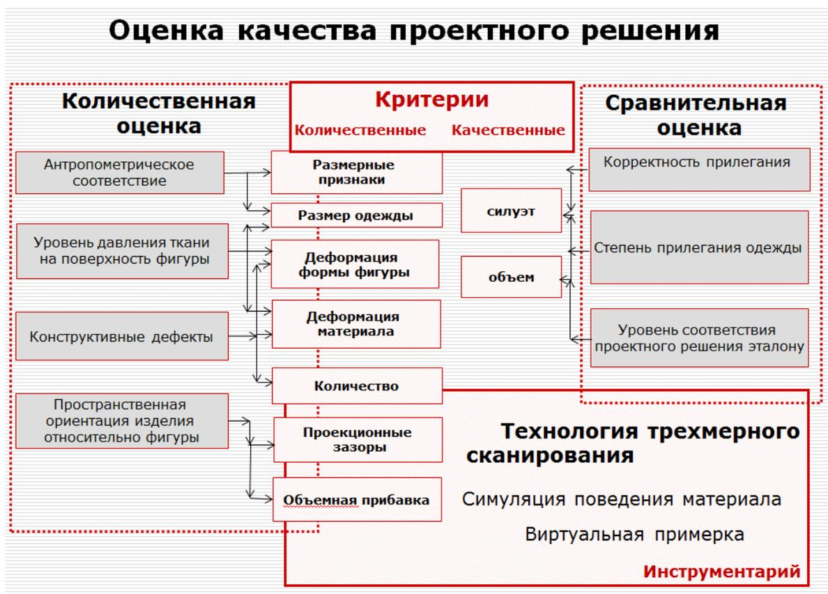
**Рисунок 5.1 - Концептуальная модель оценки качества проектных решений одежды на основе 3D сканирования**
