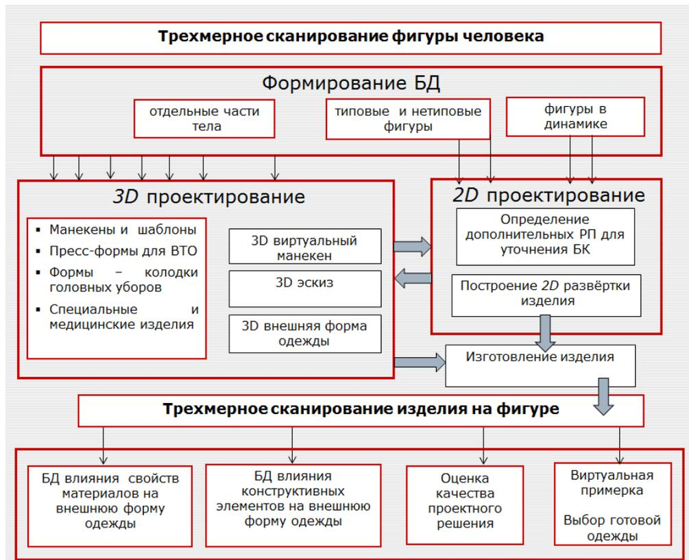
**Рисунок 6.1 – Структура процесса проектирования внешней формы швейных изделий с помощью *3D* сканирования**
