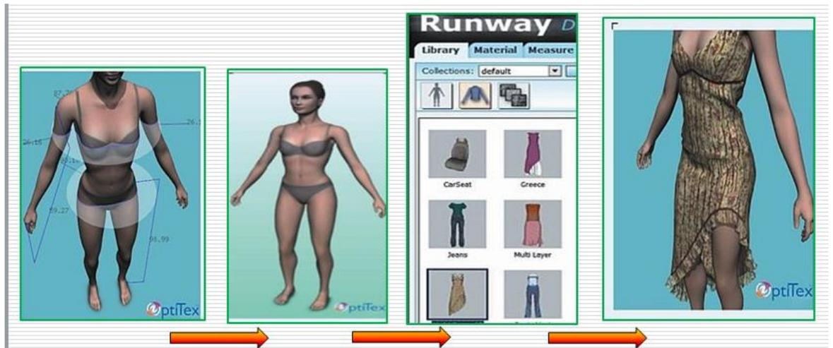
**Рисунок 2.7 – Одевание базовой формы изделия на виртуальный манекен заданной фигуры в САПР одежды *Runway Designer* [551]**
