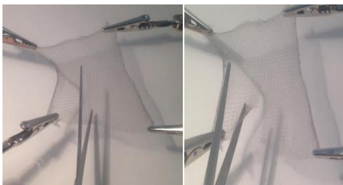
Рисунок 2.13 – фотографии исследования образца на устойчивость структуры к разрезанию
