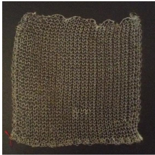
Рисунок 3.24 – Программа вязания и образец эндопротезов прямоугольной формы
