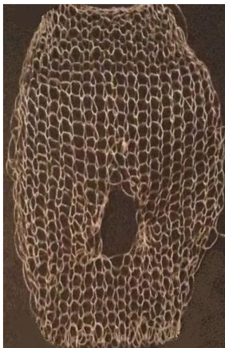
Рисунок 3.34 – Программа вязания и образец эндопротеза неразрезной формы с внутренним отверстием
