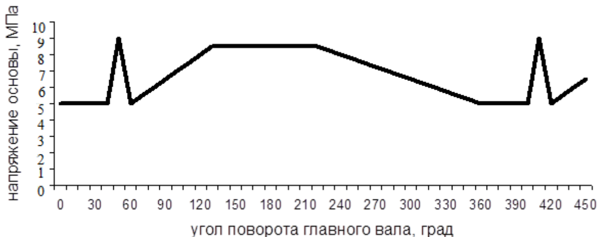
Рисунок 3-2 График напряжения основы за один оборот главного вала ткацкого станка
