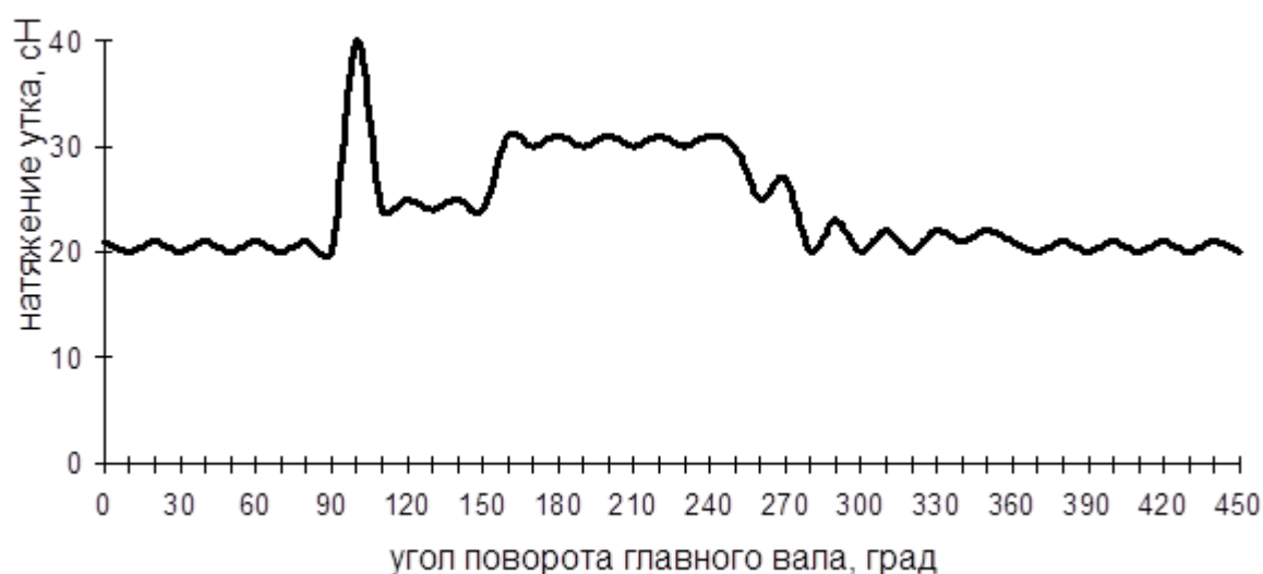
Рисунок 3-5 Осциллограмма натяжения уточной нити за один оборот главного вала на ткацком станке СТБ
