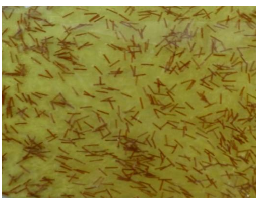
Рис. 6.4. Влияние содержания вязкозных волокон в ВОАД на их распределение в вулканизате
