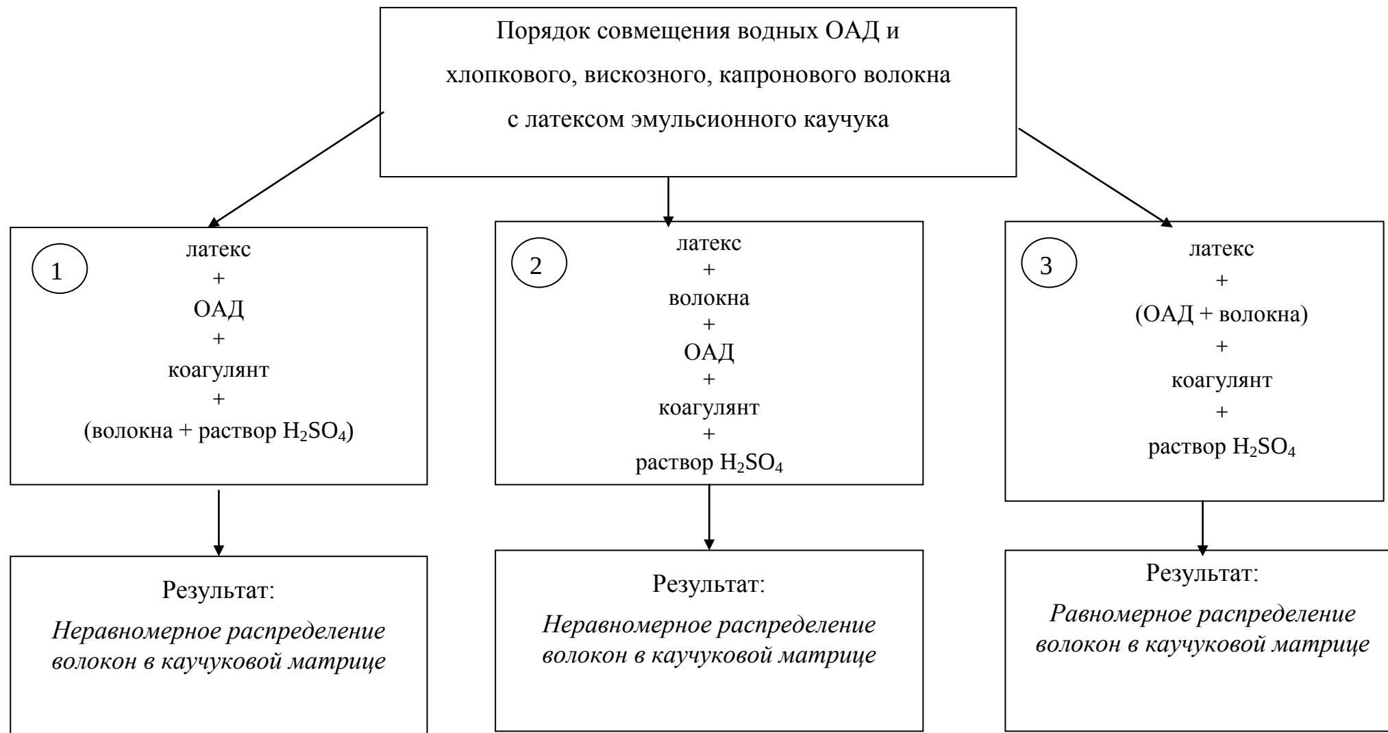
Рис. 6.1. Порядок совмещения водных ОАД и волокнистых добавок с латексом эмульсионного каучука
