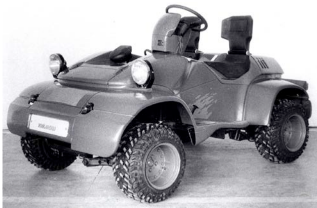
Рисунок А.80 – Мотомашина – квадрицикл с автомобильными органами управления
