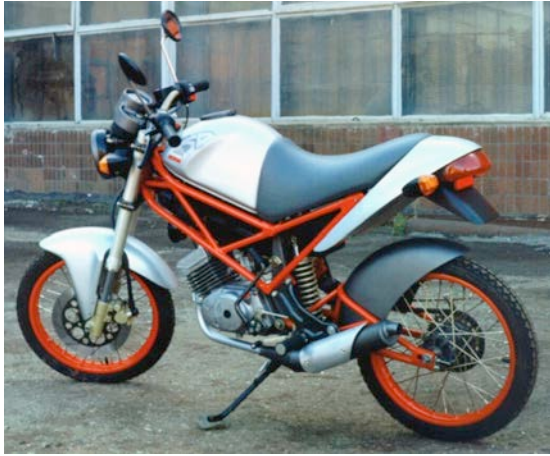
Рисунок Б.60 – Малокубатурный мотоцикл с пространственной рамой
