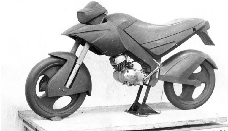
Рисунок Б.58 – Макет малокубатурного мотоцикла с хребтовой рамой
