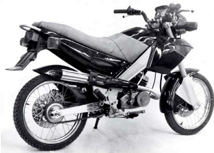
Рисунок Б.59 – Малокубатурный мотоцикл с хребтовой рамой
