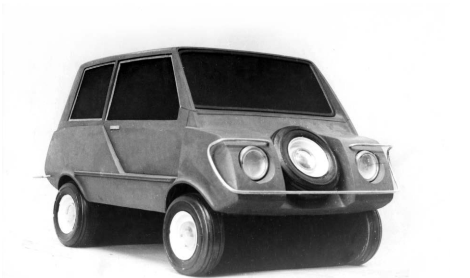
Рисунок А.75 –Макет лёгкого автомобиля для сельской местности с узлами и агрегатами от мотоцикла
