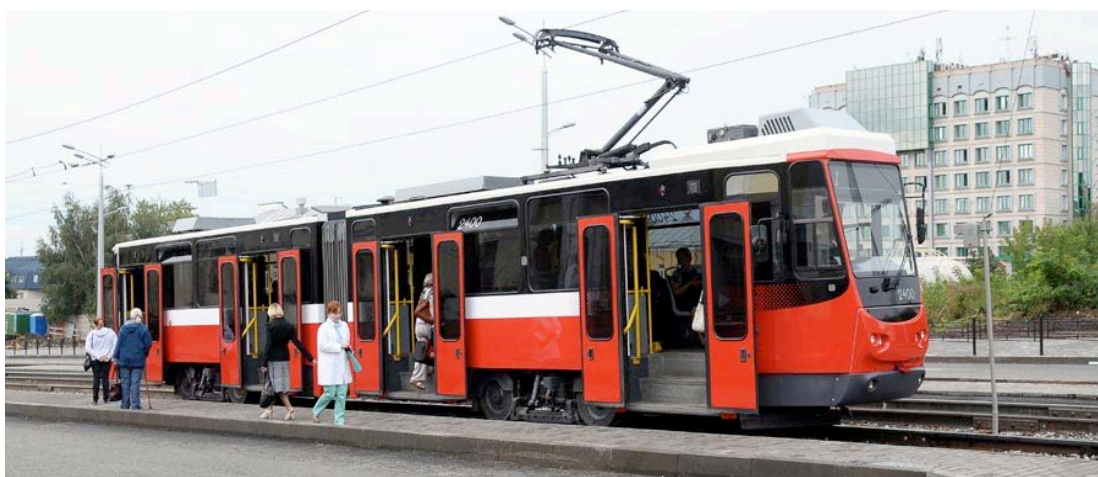
Рисунок Б.65 – Модернизированный трамвайный вагон «Татра КТ4D-Иж», 2014
