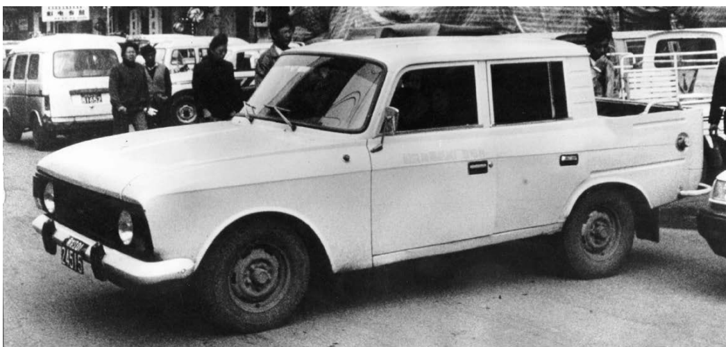
Рисунок Б.44 – Экспериментальный «ИЖ» с кузовом «четырёхдверный пикап» в Китае
