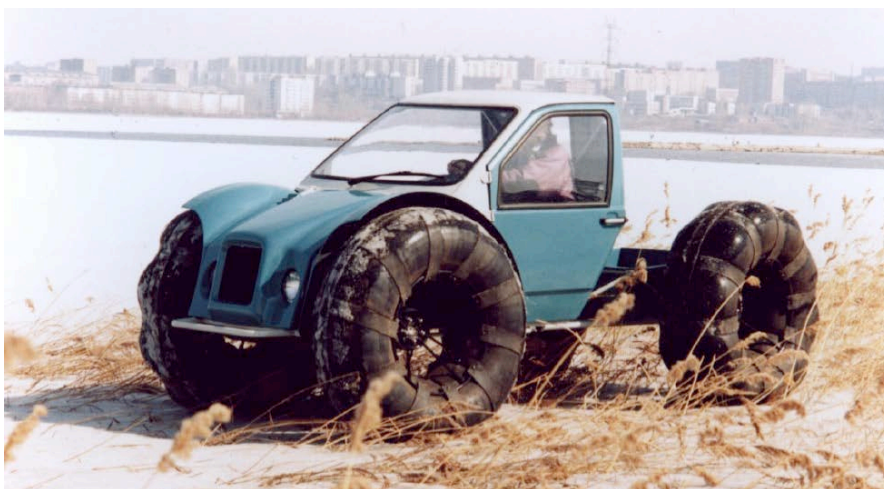
Рисунок А.86 – Вездеход с шарнирно-сочленённой рамой
