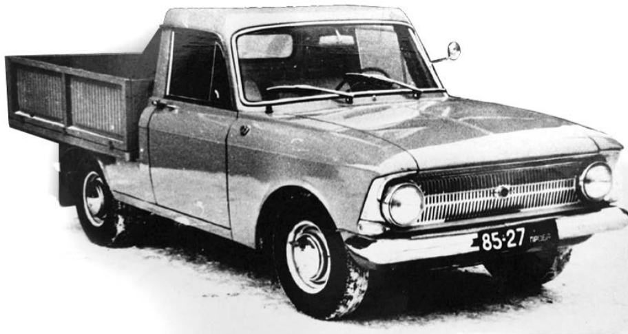
Рисунок Б.26 – Опытный образец ИЖ-2715 с бортовой платформой и высокой крышей
