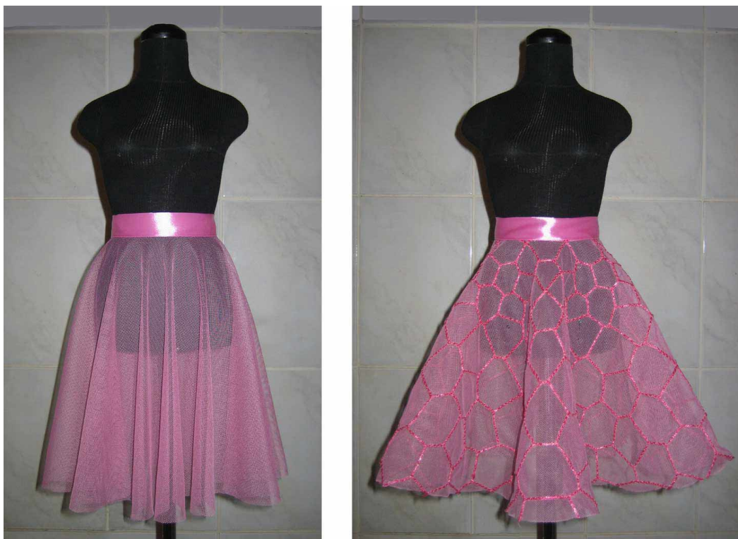
Рисунок 4.90 - Поясное изделие без армирования и с армированием
