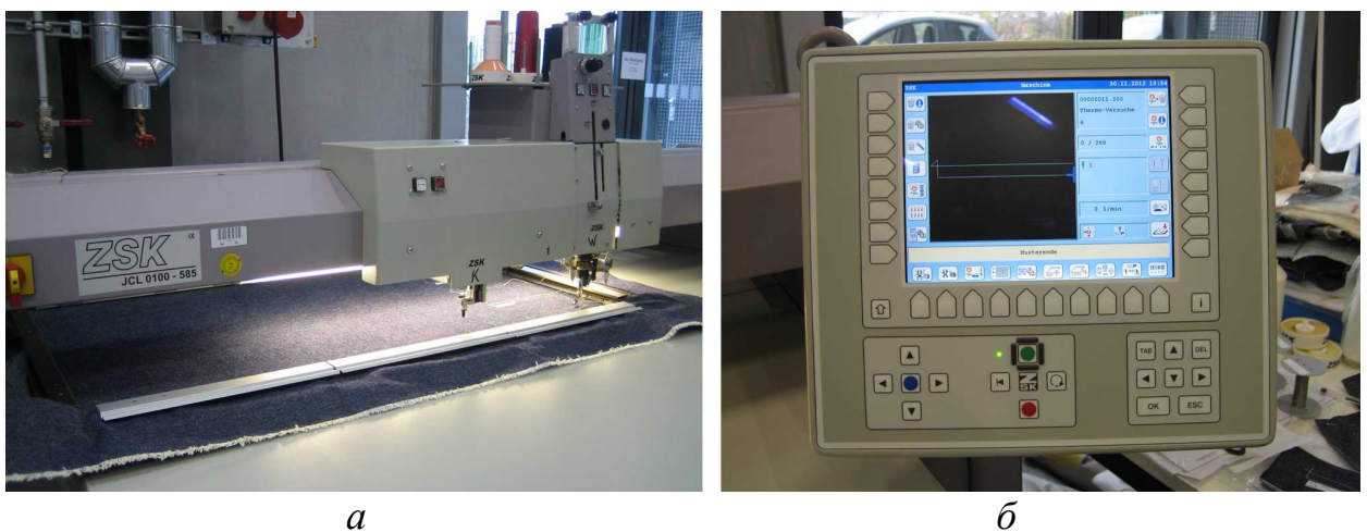
Рисунок 4.71 - Вышивальная машина ZSK: а - рабочая поверхность с заправленным в раму материалом; б - панель управления
