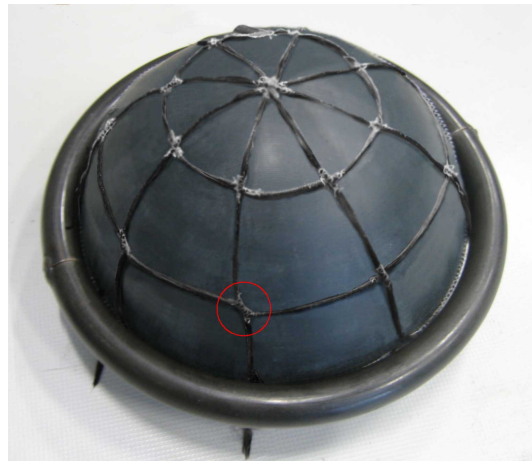
Рисунок 4.76 - Формообразование полусферической оболочки с дугообразными радиальными нитями
