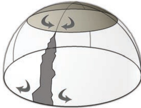
Рисунок 3.59 - Сжатие и растяжение в полусферической оболочке
