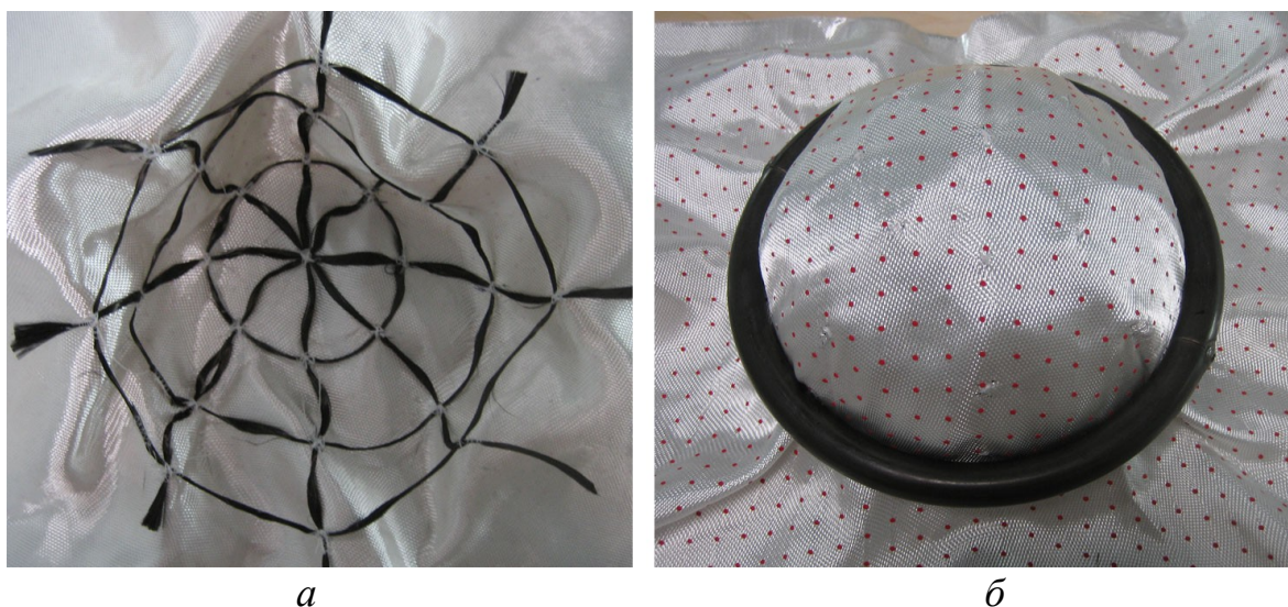
Рисунок 4.85 - Армирующий ровинг, прикрепленный к стеклоткани: а - изнаночная сторона образца, б - лицевая сторона
