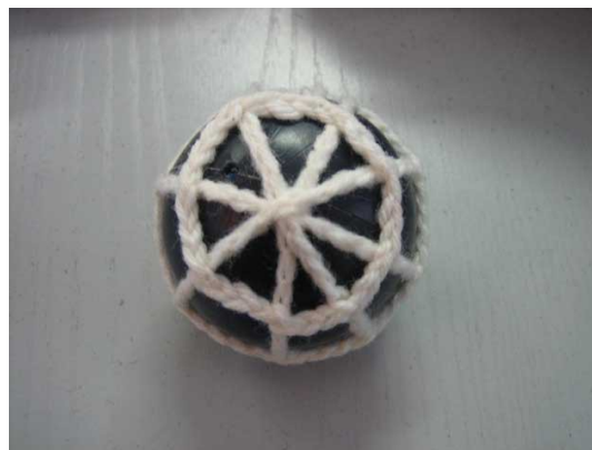
Рисунок 4.69 - Макет сферической оболочки со структурой паутины, изготовленная методом вязания
