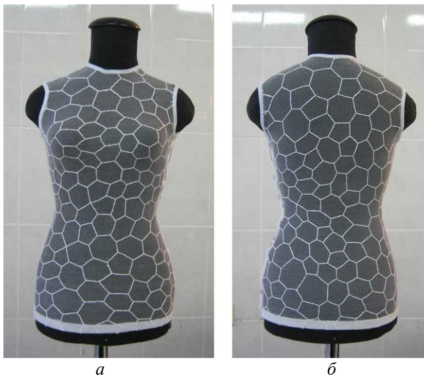
Рисунок 4.67 - Макет армированной трикотажной оболочки: а - вид спереди; б - вид сзади
