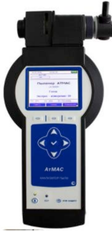
Рисунок 4.61 — Анализатор пыли «Атмас».
