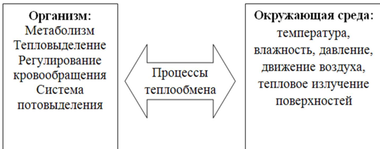
Рисунок 1.3 — Схема теплообмена между организмом человека и микроклиматической производственной средой
