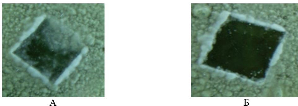
Рис. 4. Фотографии полиэтиленовых пленок, содержащих антимикробные добавки при исследовании материалов на грибостойкость в отношении грибов рода Penicillium spp.: А – ПЭ без добавок (контроль) Б – ПЭ -ЭД-160
