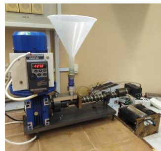
Рис. 2. Лабораторная экструзионная установка для получения плоских пленок
