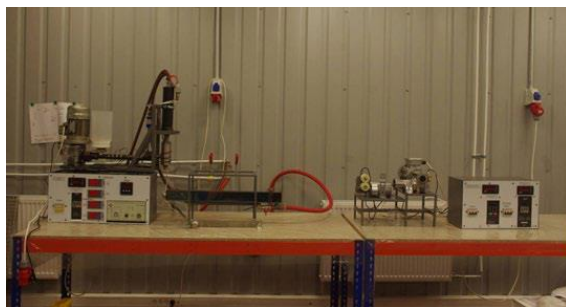
Рис. 1. Лабораторный экструдер с ультразвуковой обработкой расплава
