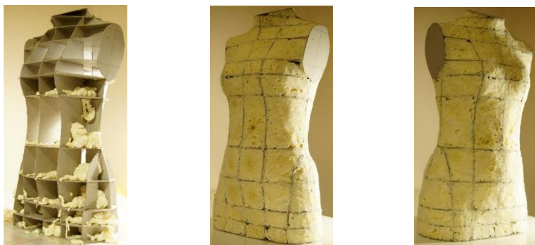
Рисунок 66 – Заполнение модели монтажной пеной
