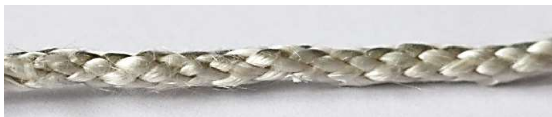
Рис. 1 Фотография шнура из крученых нитей оксида алюминия с 6-ти кратным увеличением
