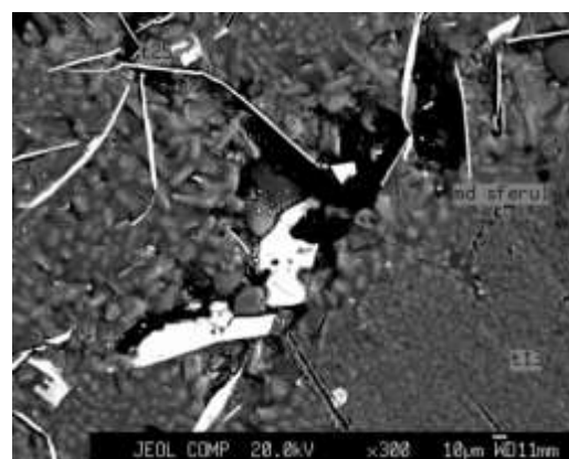
Рис. 3. Микрошлиф – сферолиты и граница между ними на сплаве AlSi11MgSr
