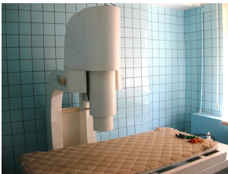
Рисунок 3 – Действующий образец 7-канального диагностического МКГ-комплекса, установленный в ЦКБ РАН (поликлиника №3)
