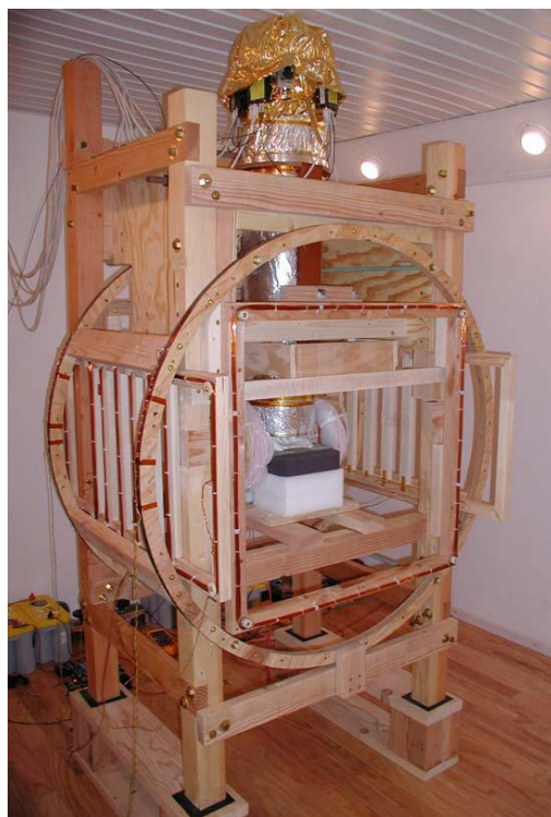
Рисунок 4 – Действующий макет установки магнитно-резонансной томографии в Los Alamos National Laboratory, США, имеющий компоненты, разработанные специалистами ИРЭ им. В. А. Котельникова РАН
