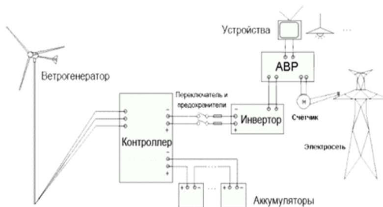
Рисунок 1 – Принципиальная схема работы ветроэнергетической установки.
