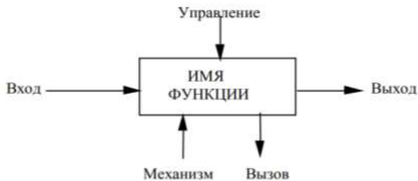
Рис. 2. Функциональный блок и виды стрелок к нему
