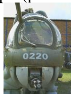
Рисунок 3 – Лобовое бронестекло кабины вертолёта Ми-24
