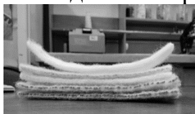
Рисунок 2 – Подготовленные для испытаний образцы комбинированного материала со слоем разреженного трикотажа
