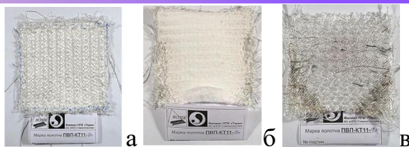
Рисунок 3 – Образцы полотна ПВП КТ-11-9Л до и после нагрева
