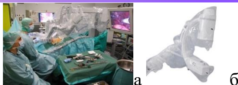
Рисунок 1 – а) чехол из пленки полиуретановой в процессе использования; б) чехол из пленки полиуретановой в готовом виде
