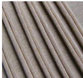
Рисунок 2 – Трикотажное переплетение кулирная гладь.
