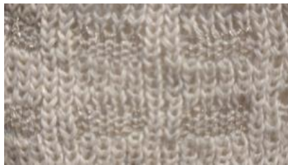
Рисунок 3 – Структура двойного двухцветного рельефно- накладного трикотажа.
