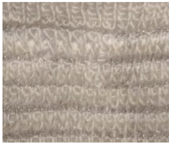
Рисунок 1 – Структура двойного комбинированного переплетения.
