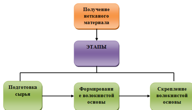
Рисунок 1 – Технологическая схема получения утеплительного материала из конопли и шерсти.
