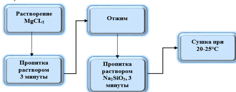
Рисунок 3 – Технологическая схема придания огнестойких свойств нетканому материалу из волокон конопли.
