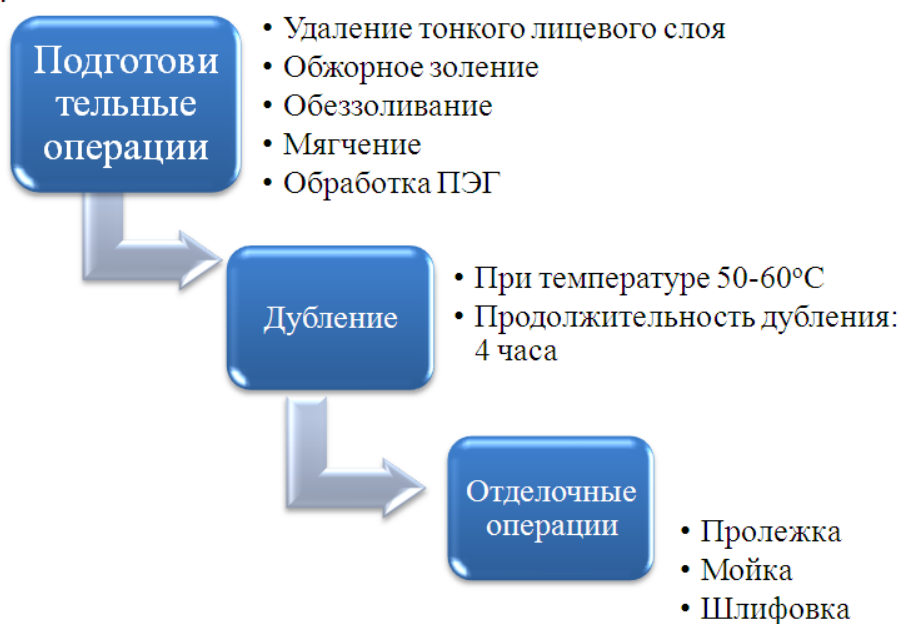
Рисунок 2. Новая технологическая схема получения натуральной замши.
