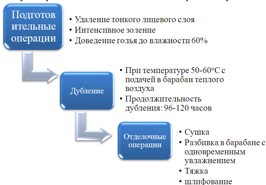
Рисунок 1. Традиционная схема получения натуральной замши.
