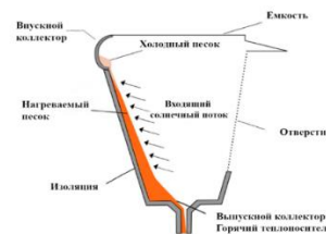
Рисунок 2 – Схема передачи тепловой энергии в приемнике прямого поглощения
