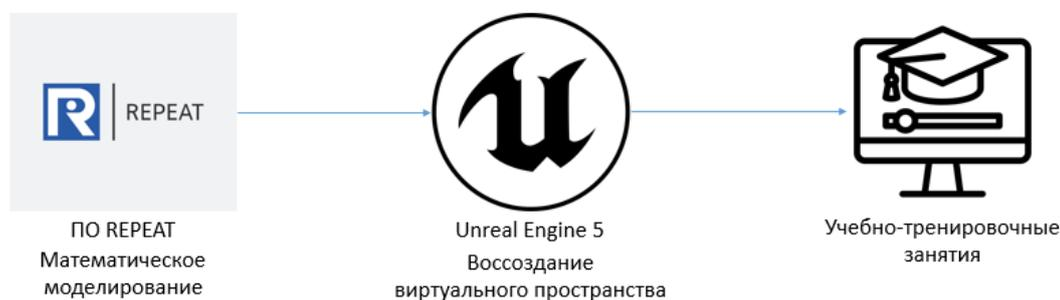
**Рис. 2. Принцип работы аналитического тренажера**
