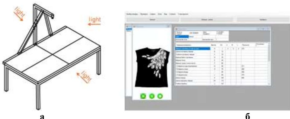
Рис. 2. Комплектация программно-аппаратного комплекса GarmentScanner: а – испытательный стенд; б – интерфейс программы
