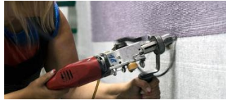
Рисунок 1 – Аппарат для ручного тафтинга.
