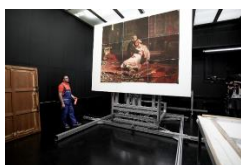
Рисунок 1 – Крупноформатный реставрационный стол-трансформер
