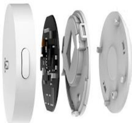
Рисунок 2. Внешний вид внешнего температурного датчика входящего в состав подсистемы
