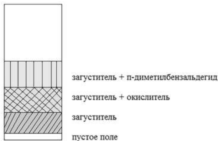
Рис.1. Последовательность слоев реагентов тест-полоски
