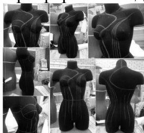
Рисунок 2 – Разметка композиционных и конструктивных линий на манекене
