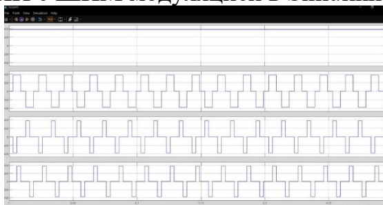
Рисунок 4 – Выходные данные пофазного напряжения АИН в Simulink
