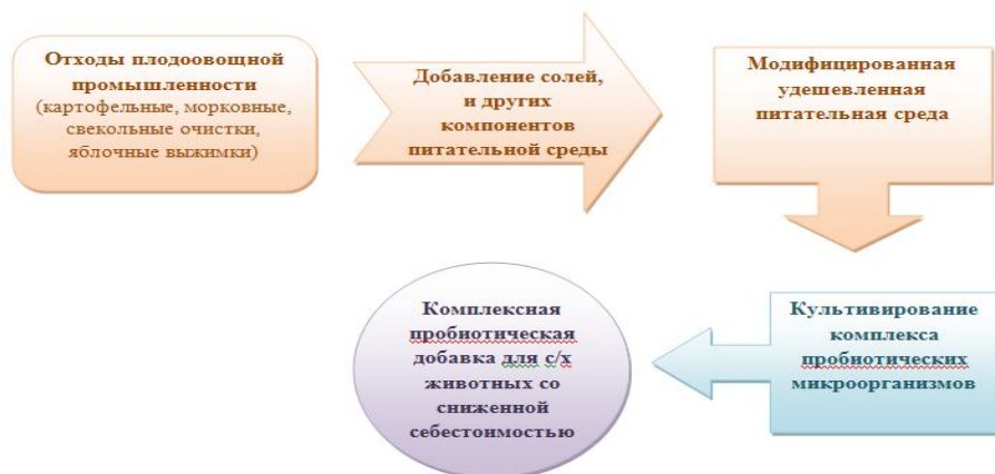
Рис. 3. Схема производства пробиотической кормовой добавки
