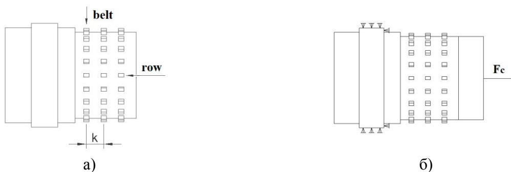
Рис. 2. Схемы расположения шипов (а) и нагружения (б).
