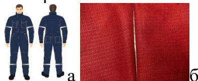
Рисунок 1 – а) мужской комбинезон; б) ткань арамидная до стирки (слева) и после 5 стирок (справа)
