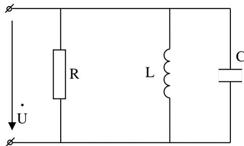
Определите токи в ветвях, общий ток и его угол сдвига фаз относительно напряжения. Постройте векторную диаграмму.
