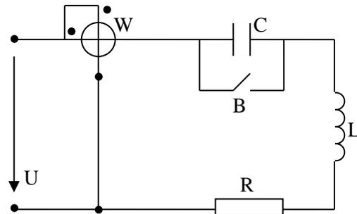
Определите показания ваттметра при замкнутом и разомкнутом выключателе «В»
