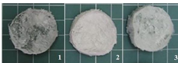
Рисунок 55 – Фотографии макропористых матриц на основе сшитого хитозана и гиалуроновой кислоты: 1 – матрикс без ГК-На; 2 – поверхностная модификация ГК-На; 3 – матрикс на основе дисперсии полимеров
