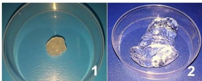
Рисунок 63 – Образец гидрогеля хитозана, полученный в присутствии уксусной кислоты до (1) и после (2) достижения равновесной степени набухания в воде. Условия получения приведены в п.1 таблицы 10.
