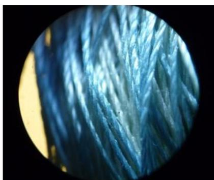
Рисунок 73 - Фотография бикомпонентной шовной нити из фиброина, поверхностно-модифицированной раствором хитозана в присутствии дженипина, и раствором ГК-На.
