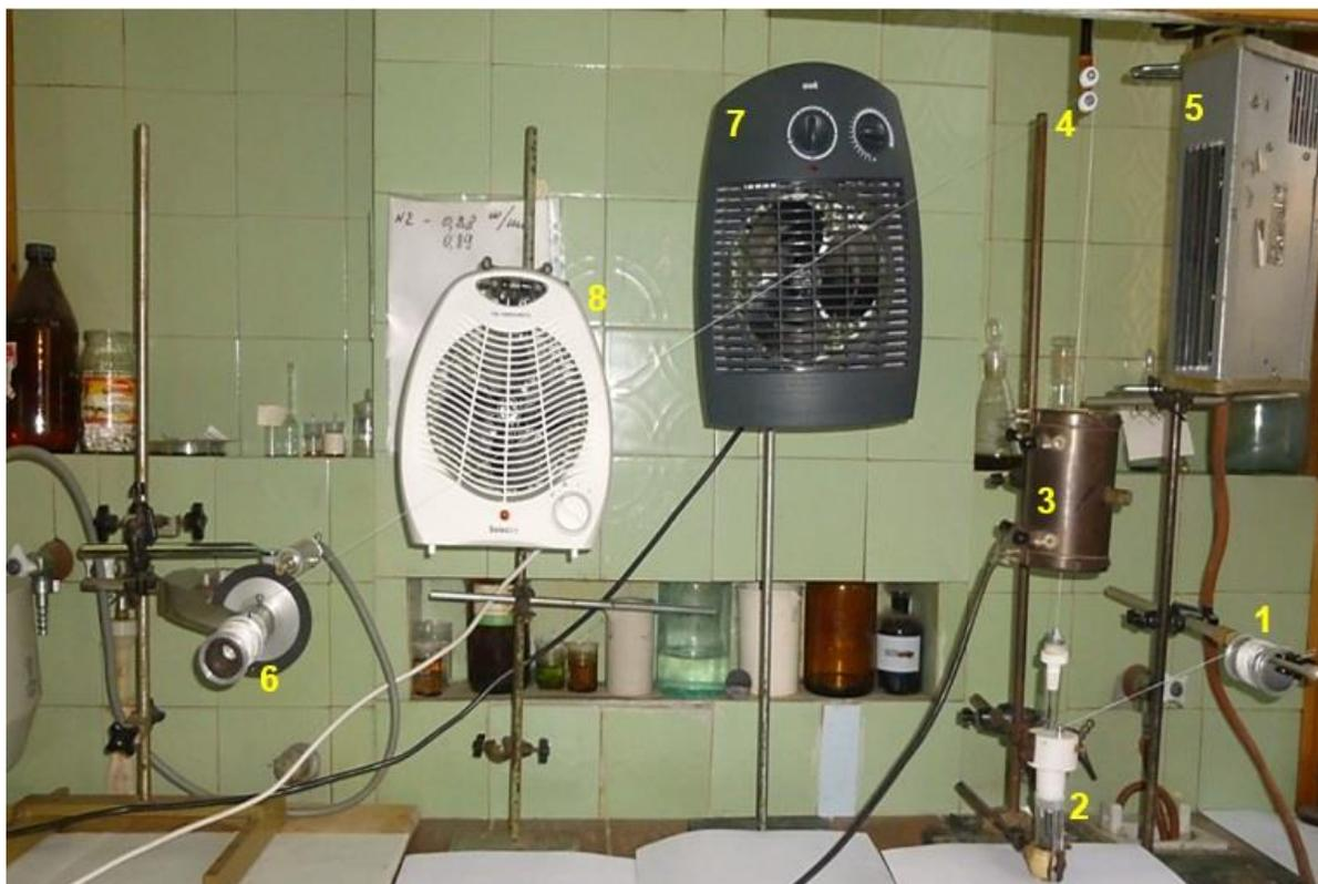
Рисунок 21 - Экспериментальная установка для послойного нанесения растворов полимеров на хирургические нити. 1 – входная паковка; 2 – фильтрный комплект; 3 – печь; 4- приемный ролик; 5 – тепловентилятор; 6 – приемная бобина; 7,8 – тепловентиляторы
