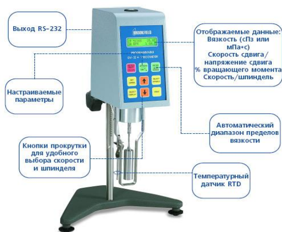
Рисунок 3 - Ротационный вискозиметр «Brookfield RVDV-II+».
