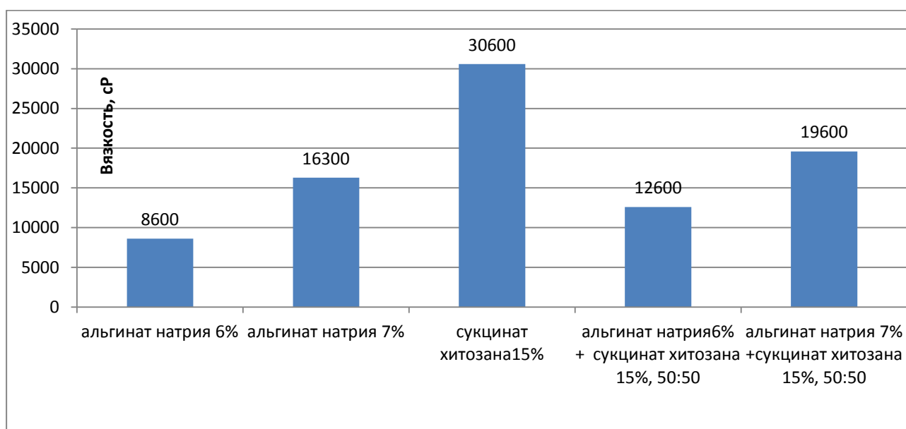
Рисунок 18 - Вязкость полимерных композиций и их смесей (данные приведены при скорости 20\text{с}^{-1} об/мин)
