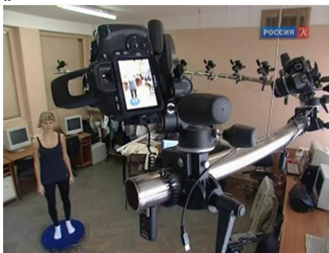
Рисунок 8 – Стационарная система 3D сканирования: а - принципиальная схема; б – внешний вид
