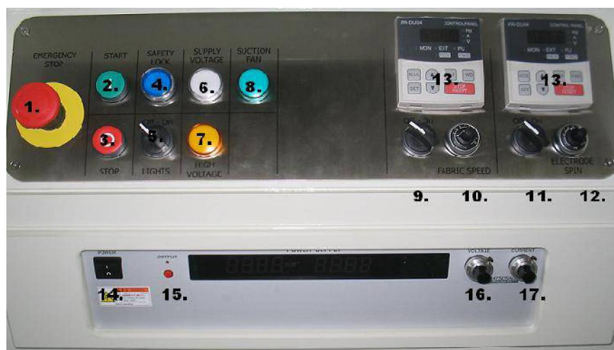
Рисунок 13 – Внешний вид пульта управления установкой NS LAB: 1 – Кнопка экстренной остановки; 2 – Кнопка «Старт»; 3 – Кнопка «Стоп»; 4 – Кнопка защитной блокировки с подсветкой; 5 – Выключатель подсветки формовочной камеры; 6 – Индикатор наличия питания; 7 – Индикатор наличия высоковольтного питания; 8 – Индикатор эффективности вентиляции; 9 – Выключатель движения подложки; 10 – Регулятор скорости движения подложки; 11 – Выключатель вращения электрода; 12 – Регулятор скорости вращения электрода; 13 – Частотомеры заданной для подложки и электрода частоты; 14 – Тумблер включения высоковольтного генератора Matsusada; 15 – Кнопка подачи напряжения с высоковольтного генератора Matsusada; 16 – Регулятор напряжения высоковольтного генератора; 17 – Регулятор тока высоковольтного генератора
