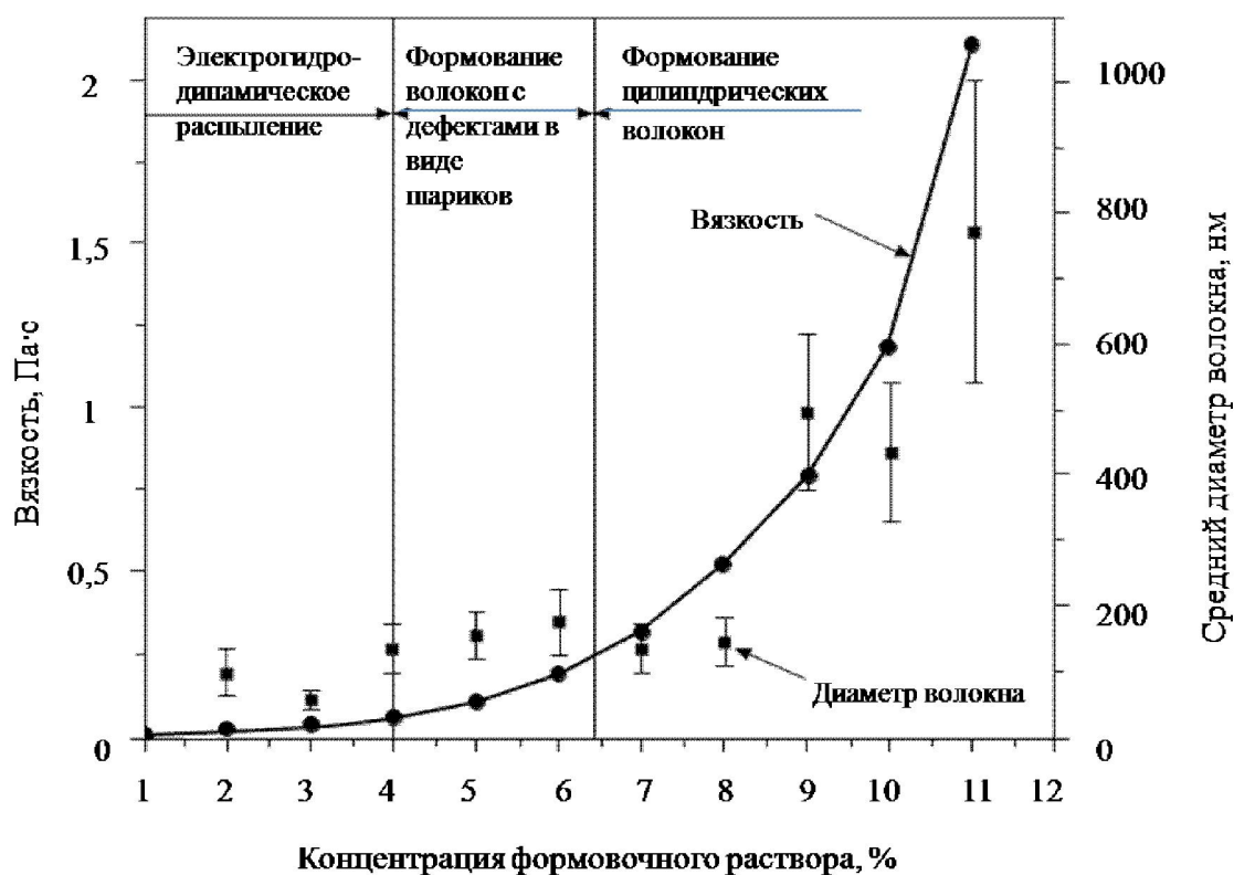
Рисунок 6 – Зависимость среднего диаметра ПАИ нановолокон и вязкости формовочного раствора от его концентрации
