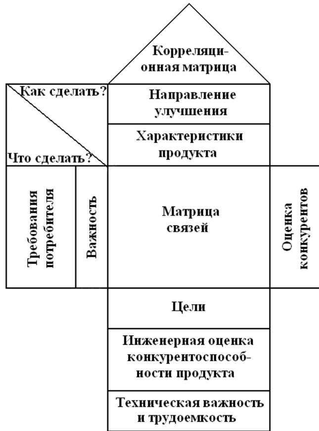
Рисунок А.3. Модель «QFD» (развертывание функций качества), или так называемое «Дом качества», Йоджи Акао (Yoji Akae).
