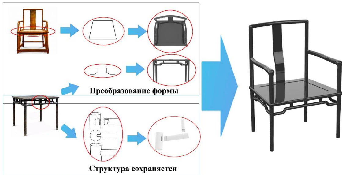
Рис. 41. Трансформация формы и структуры эргономичного стула с прямоугольной спинкой
