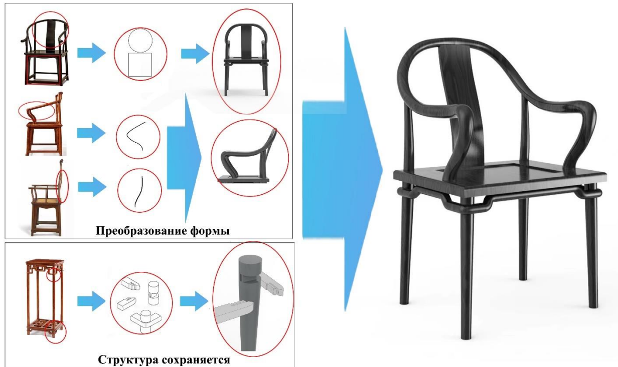
Рис. 39. Трансформация формы и структуры стула с эргономичной S-образной спинкой
