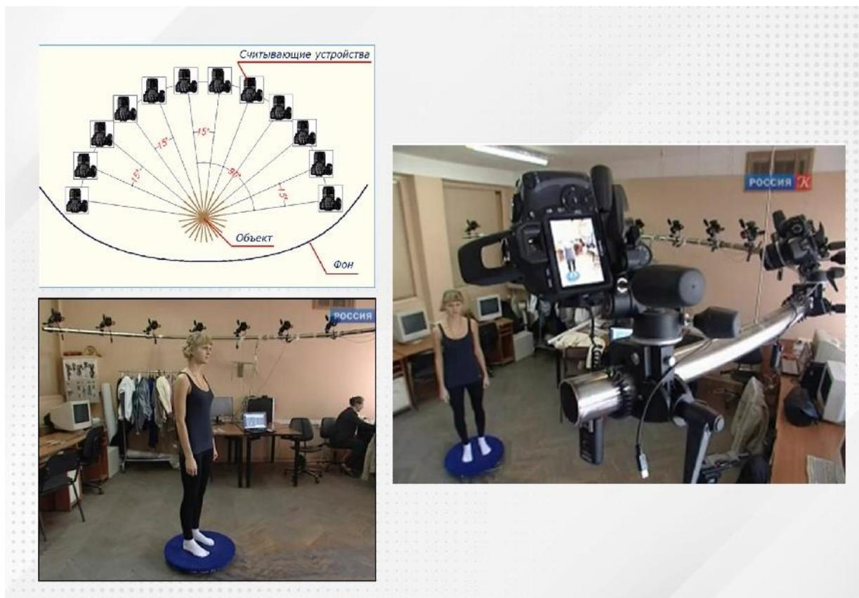
**Рисунок 1.10 – Стационарная система получения цифрового образа фигуры на основе фотокамер**
