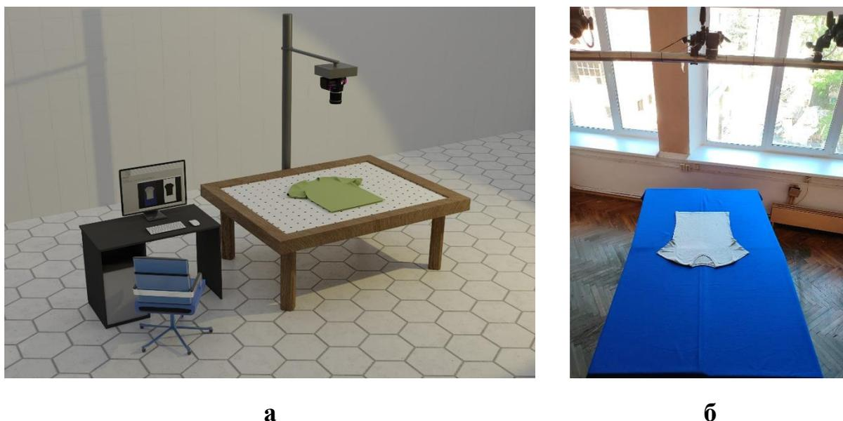
**Рисунок 3.3 – Система технического зрения для автоматизации сбора сведений об одежде: а – визуализация, б – внешний вид**
