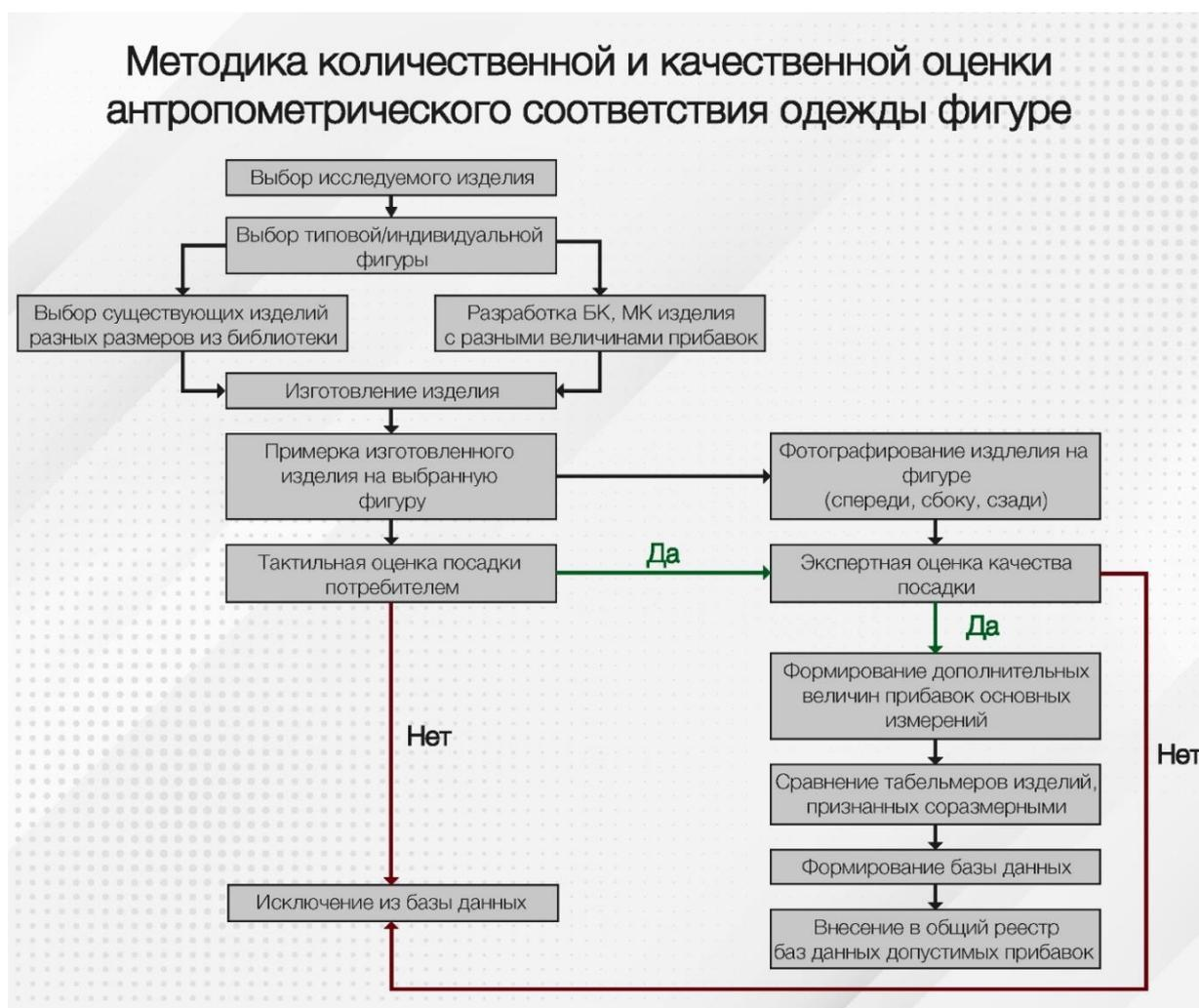
**Рисунок 2.4 – Разработанная методика количественной и качественной оценки антропометрического соответствия одежды фигуре**
