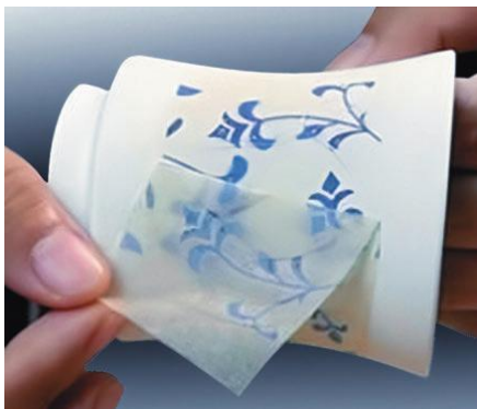
Рис.3.4 — Процесс нанесения подглазурной аппликации из бумаги
