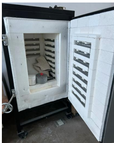
Рис. 2.5 — В настоящее время в Цзиндэчжэне используется среднетемпературная электрическая печь для обжига керамики
