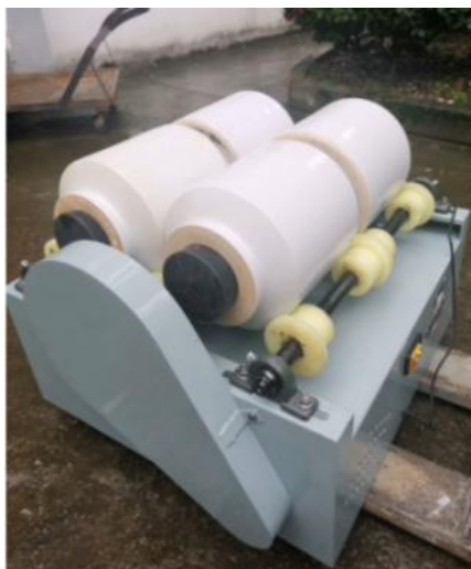
Рис. 2.9— Современные «шаровые мельницы» для измельчения кобальта
