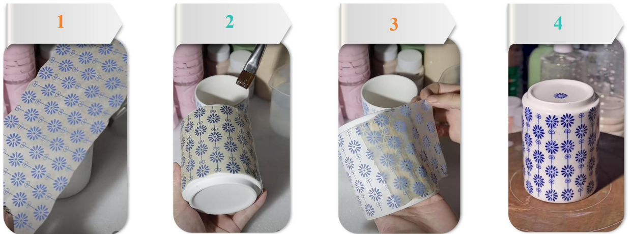
Рис. 3.5 — Производственный процесс нанесения подглазурной деколи
